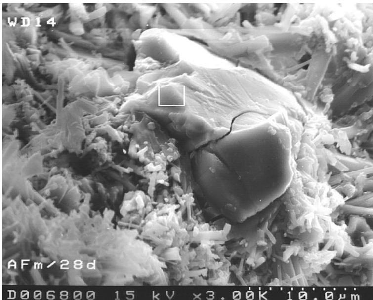
Bild 33: "Ausgelaugtes" C<sub>4</sub>AF-Korn in einer C<sub>2</sub>(A,F)-Gips-CH-Mischung [18, 19]
