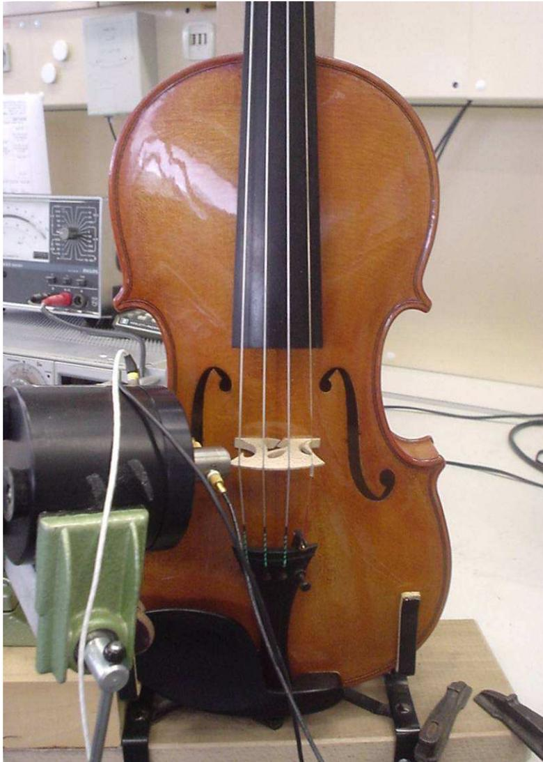
*Abb. 2.3. Violine, in die der Steg DAC eingesetzt ist.*
