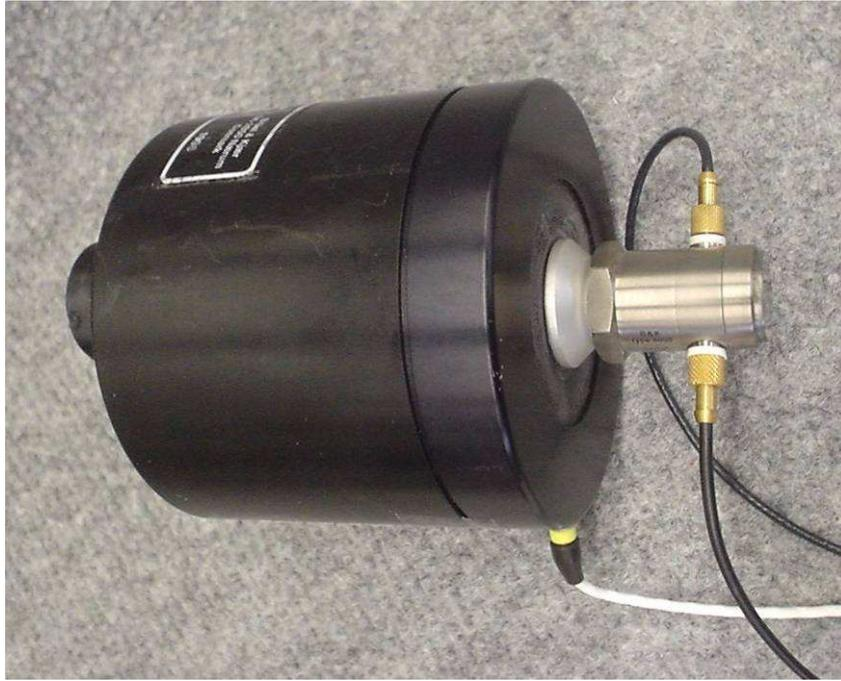
*Abb. 6.1. Schwingerreger mit aufgeschraubtem Impedanzmesskopf.*
