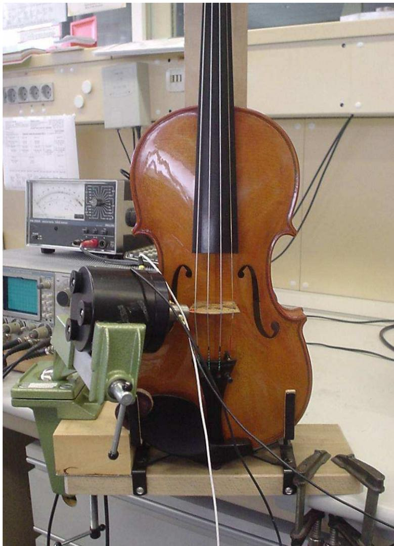
*Abb. 6.4. Messung der Admittanz am Steg DAC auf der Seite der Basssaiten.*
