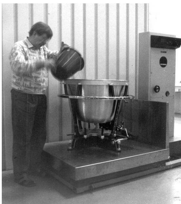
*Abb. 9.1. Bestimmung des Volumens (hier: des Kessels A) durch Füllen mit Wasser und Messen der Gewichtszunahme.*
