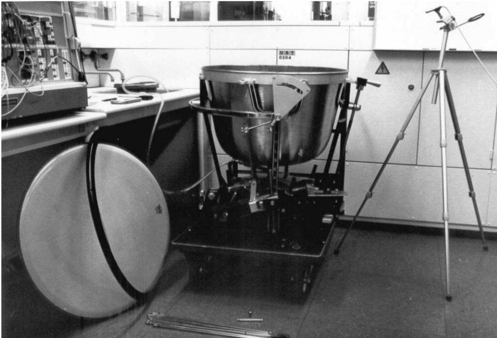
*Abb. 8.1. Pauke im Laborraum. Im Vordergrund links ist das abgenommene Fell mit dem Druckreifen zu erkennen.*
