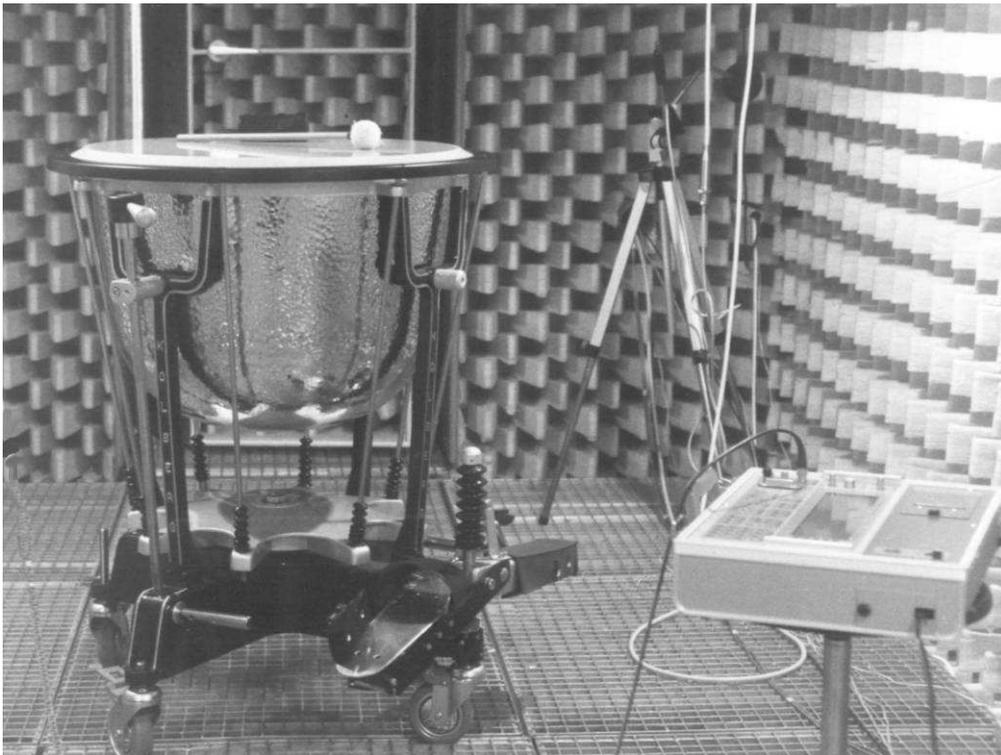
*Abb. 6.18. Kleine Pauke im reflexionsarmen Raum. Im Vordergrund ist ein FFT-Analysator, im Hintergrund das Messmikrofon zu erkennen.*
