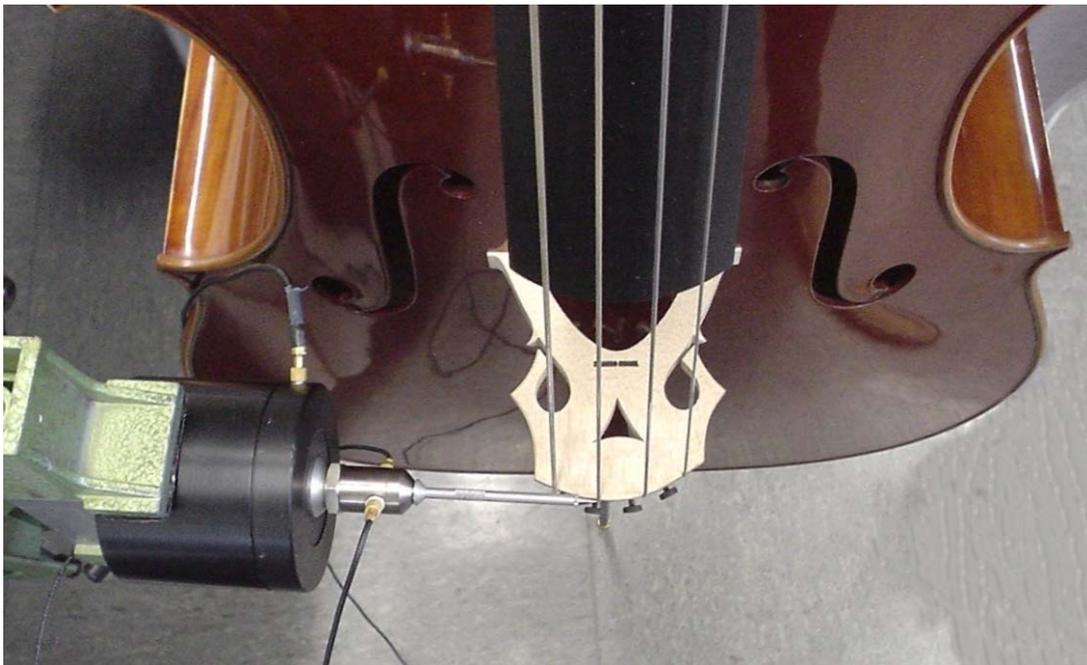
*Abb. 2.5. Admittanz-Messung in tangentialer Richtung mit Verlängerungsstück, hier am Auflagepunkt der G-Saite auf dem Premio-Steg.*
