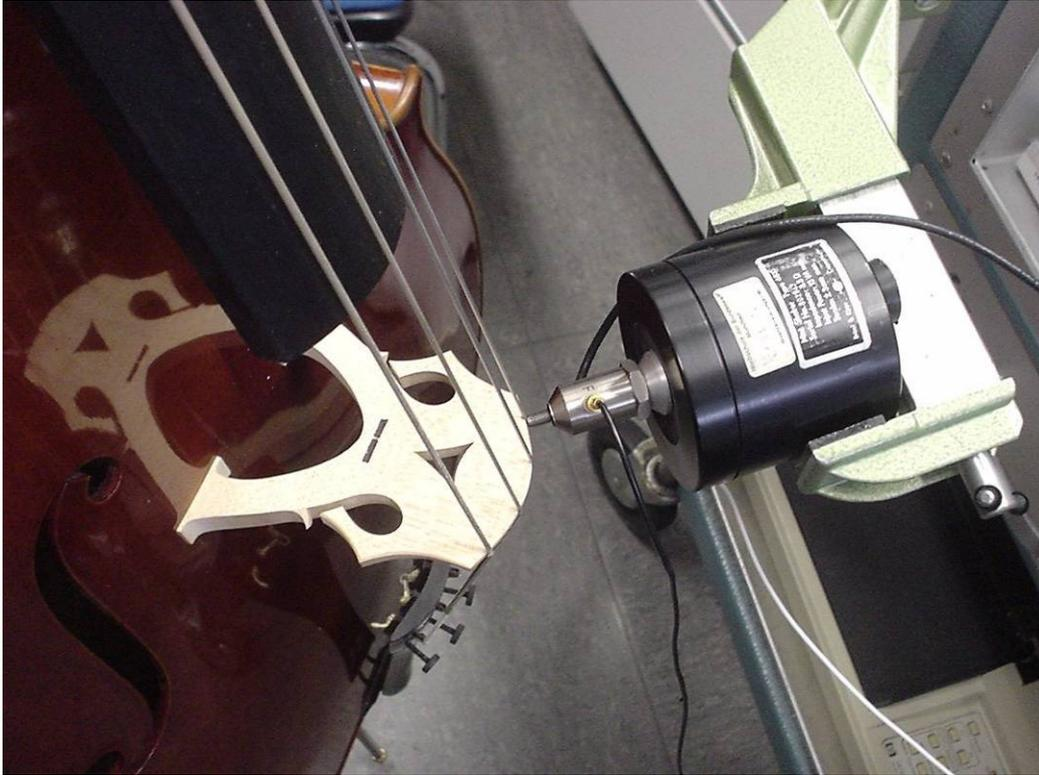
*Abb. 2.3. Messung der Admittanz in Normalenrichtung (senkrecht zum Steg), hier am Auflagepunkt der hohen a-Saite auf dem Steg N.*
