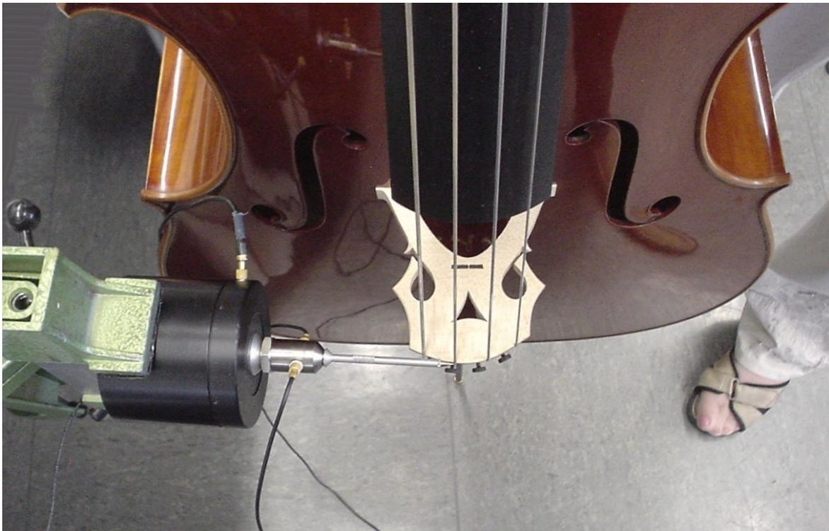
*Abb. 4.1. Messung der Admittanz in tangentialer Richtung (am Steg N parallel zur Decke), hier am Auflagepunkt der G-Saite.*
