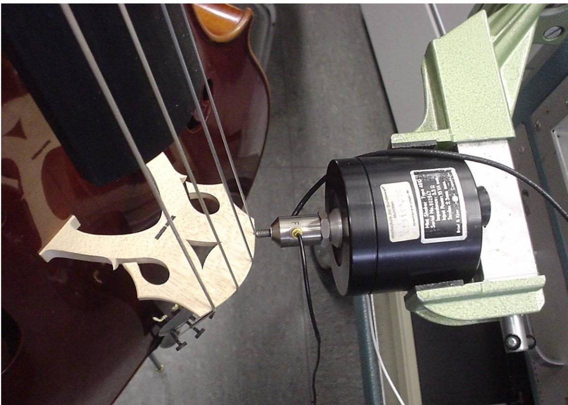
Abb. 3.1. Messung der Admittanz in Normalenrichtung (senkrecht auf dem Steg N) am Auflagepunkt der hohen a-Saite.
