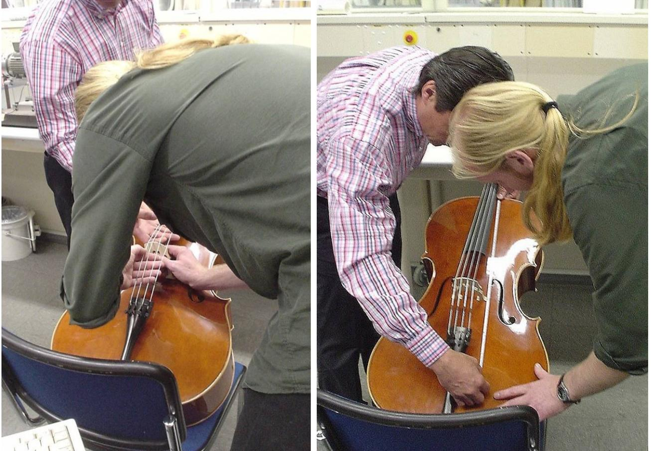
*Abb. 1.3. Die beiden Geigenbaumeister, wie sie den Steg vom Typ A einsetzen (links) und seine genaue Position vermessen (rechts).*
