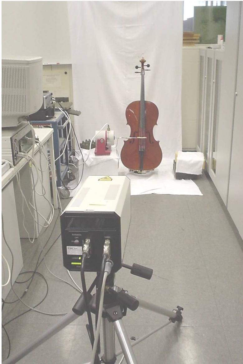
Untersucht wurden die Schwingungen der Ober- bzw. Vorderseite des Instruments. Das primäre Interesse galt Biegeschwingungen, die zur Abstrahlung von Schall führen. Gemessen
