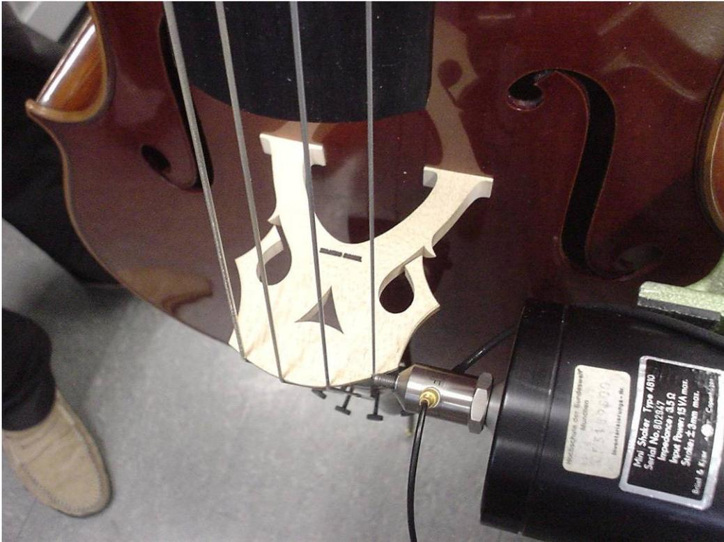
*Abb. 2.2. Messung der Admittanz in tangentialer Richtung (parallel zur Decke), hier am Auflagepunkt der hohen a-Saite auf dem Steg N.*
