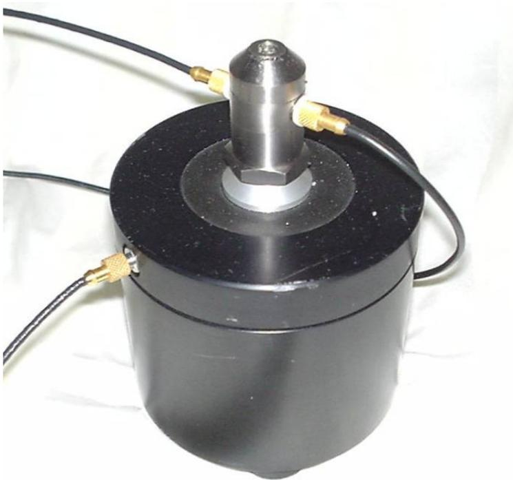
*Abb. 2.1. Schwingerreger mit aufgeschraubtem Impedanzmesskopf.*
