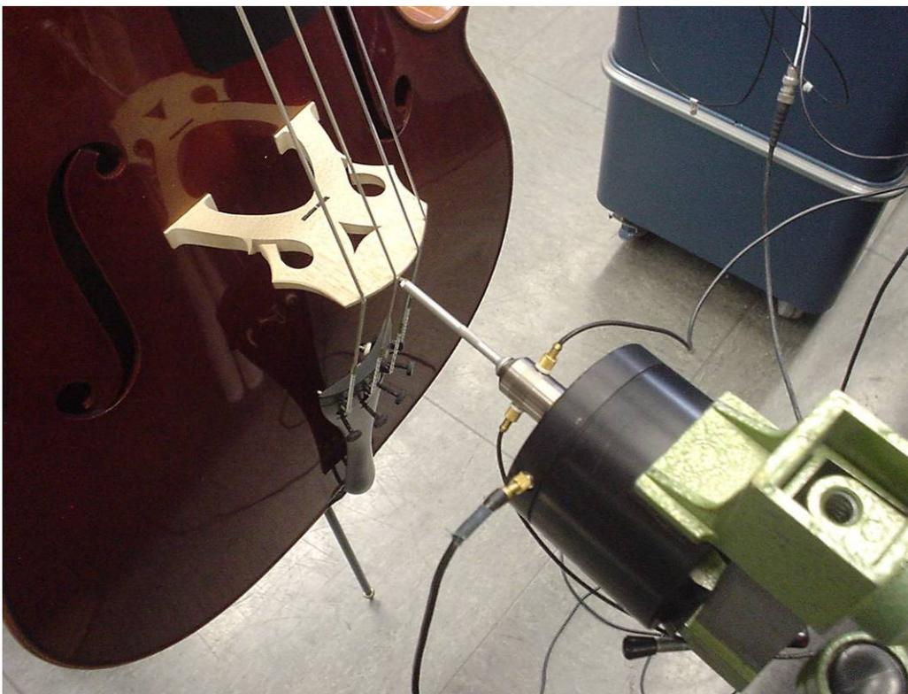
Abb. 5.1. Messung der Stegadmittanz in Normalenrichtung am Auflagepunkt der G-Saite des Steges N.
