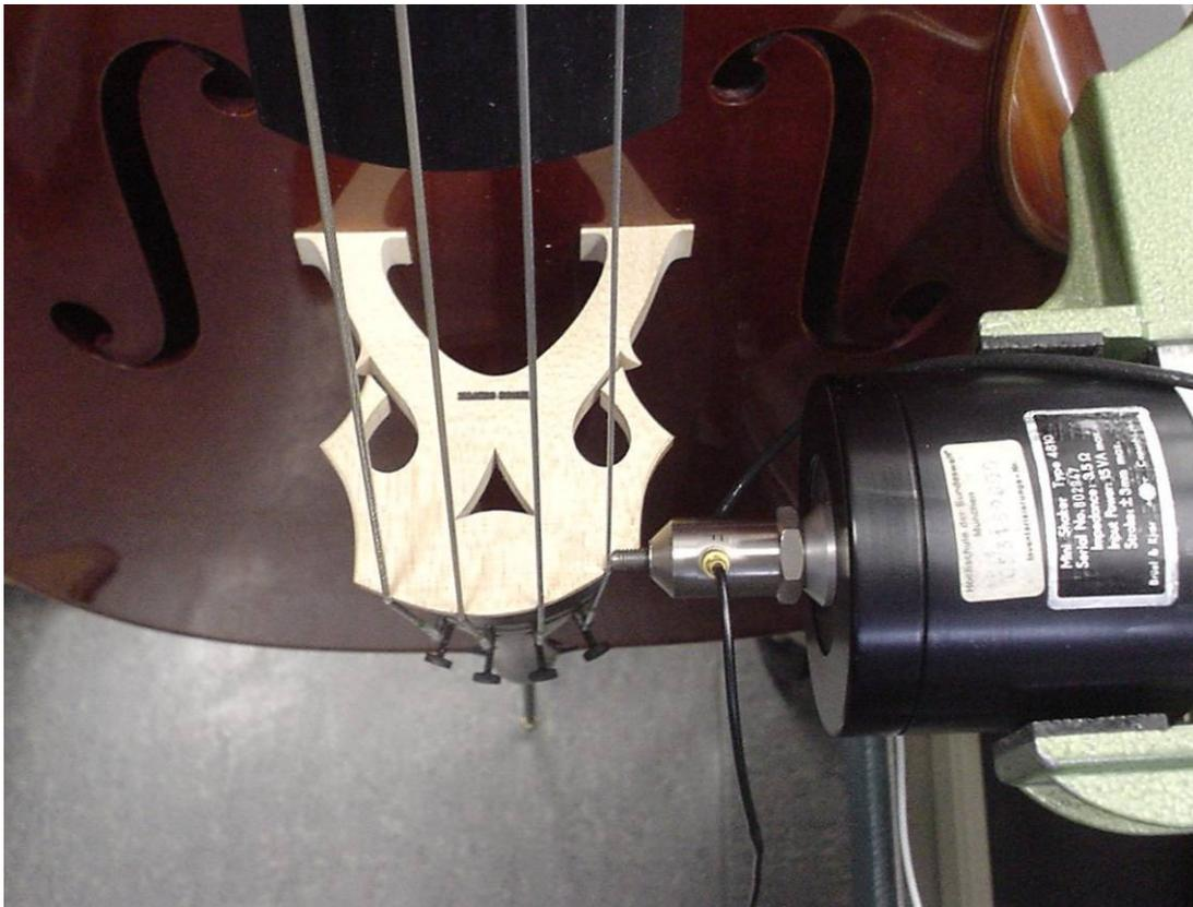
*Abb. 3.5. Messung der Admittanz in tangentialer Richtung (parallel zur Decke des Steges N) am Auflagepunkt der hohen a-Saite.*
