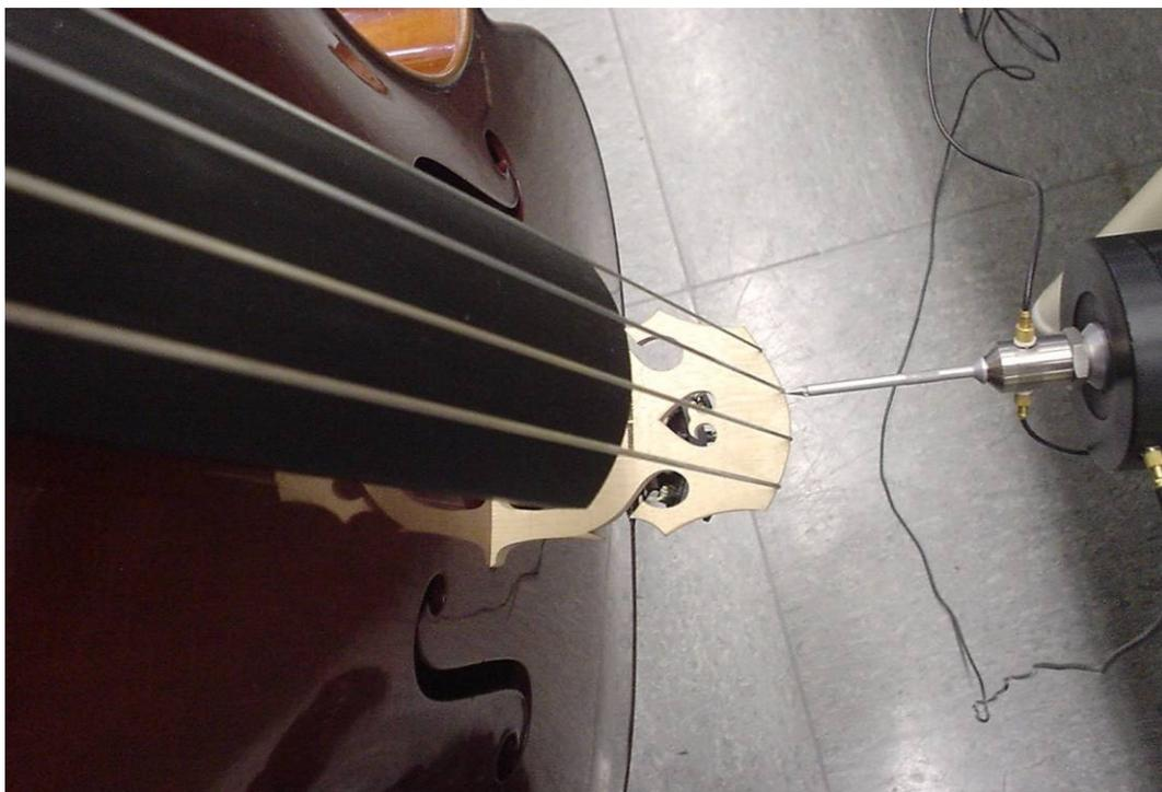
Abb. 5.6. Messung der Stegadmittanz in Normalenrichtung am Auflagepunkt der d-Saite des Steges A.
