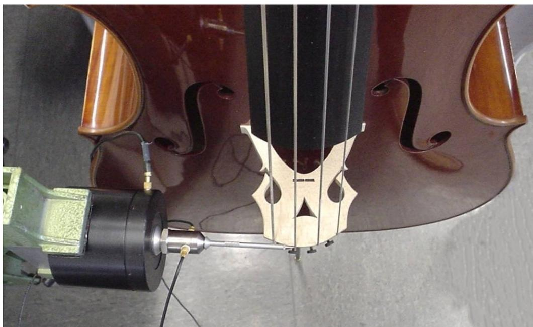
*Abb. 6.1. Messung der Stegadmittanz in tangentialer Richtung am Auflagepunkt der G-Saite des Steges N.*
