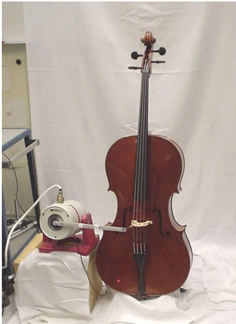
Abb. 8.2 zeigt, wie das Cello mit einem elektrodynamischen Schwingerreger LDS V404 angeregt wurde. Der Schwingerreger griff über ein Verlängerungsstück am Steg an. In Abb. 8.1 geschieht dies parallel zur Decke (tangentielle Richtung) und in Abb. 8.2 senkrecht zur Decke (Normalenrichtung). Die Erregerkraft wurde mit einem Kraftaufnehmer gemessen, der un-
