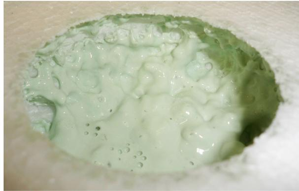
Abbildung 3.2: chemischen Reaktion zwischen Monomer und Styropor
