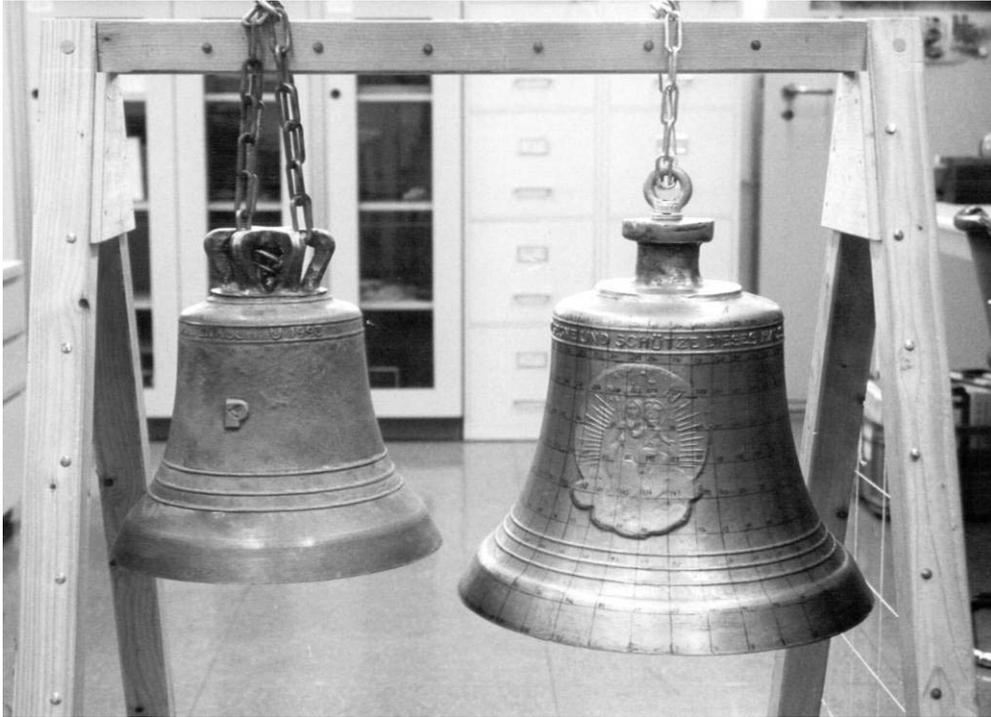
Abb. 8. Zwei kleine Kirchenglocken, aufgehängt in einem Glockenstuhl und vorbereitet für eine akustische Messung in einem Laborraum. Die hier betrachtete Glocke hängt rechts.
