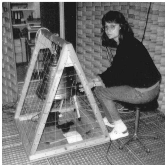
*Abb. 6. Kirchenglocke, aufgehängt in einem Glockenstuhl bei einer Messung durch Frau Dipl.-Ing. Petra Lutz.*
