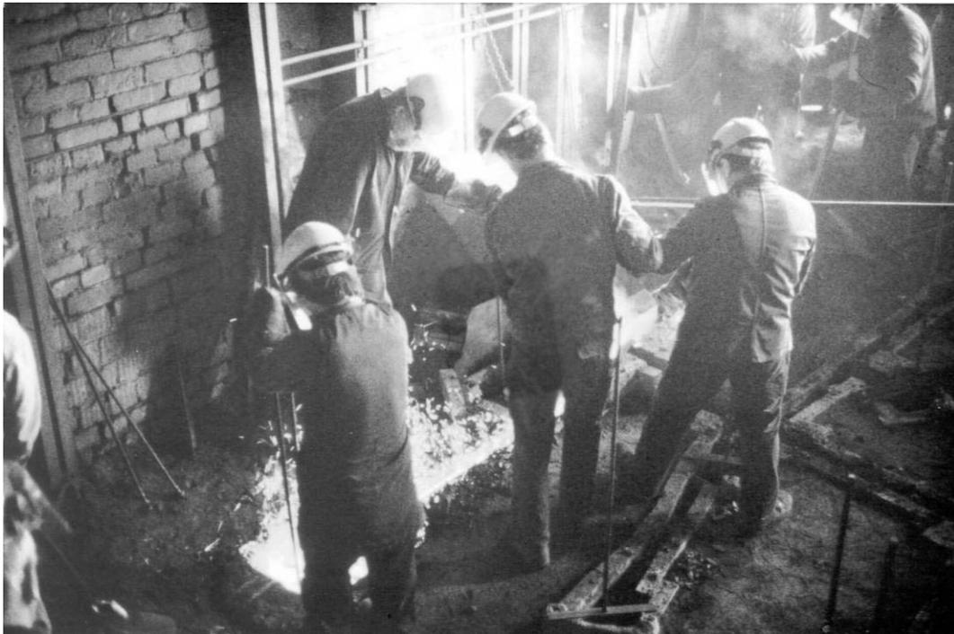
*Abb. 4. Einleiten der flüssigen Glockenbronze in die vergrabenen Gussformen.*
