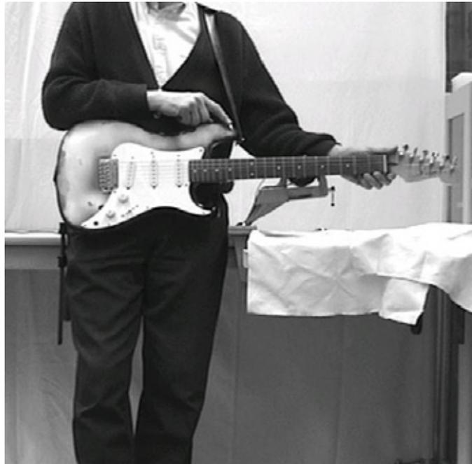
Abb. 55. Gitarre auf dem Schoss der VP FL und am Bund Nr. 7 über einen Schwingerreger B&K 4810 angeregt.
