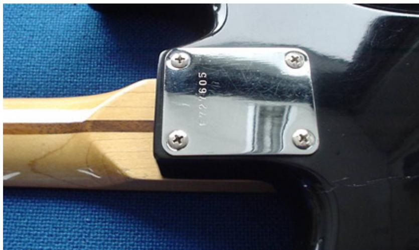
*Abb. 3. Detail auf der Rückseite der Gitarre Squier Bullet: Platte, hinter der sich die Verschraubung des Halses befindet.*
