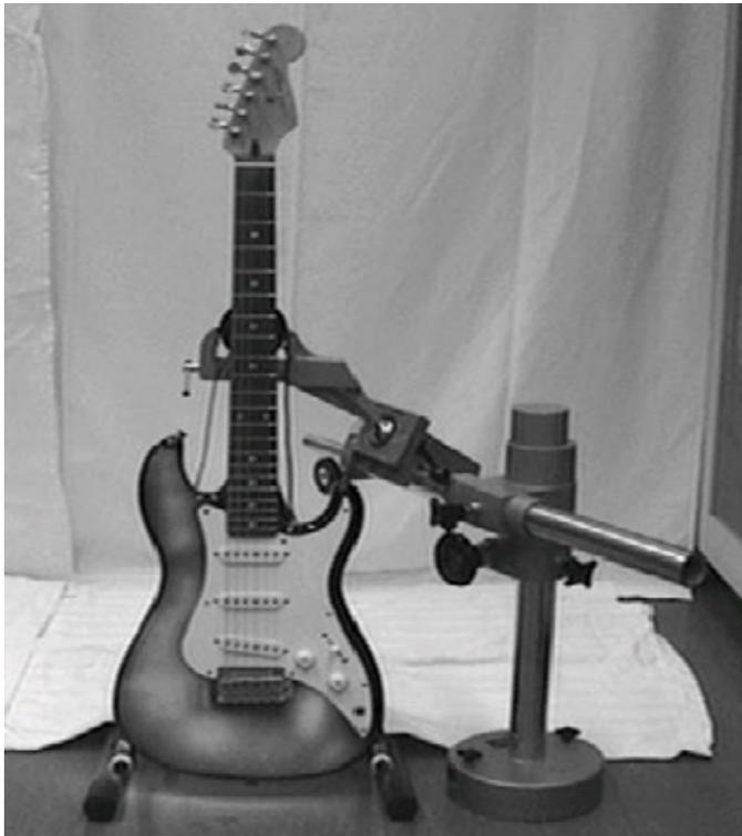
*Abb. 40. Gitarre im Gitarrenständer und am Bund Nr. 7 über einen Schwingerreger B&K 4818 angeregt.*
