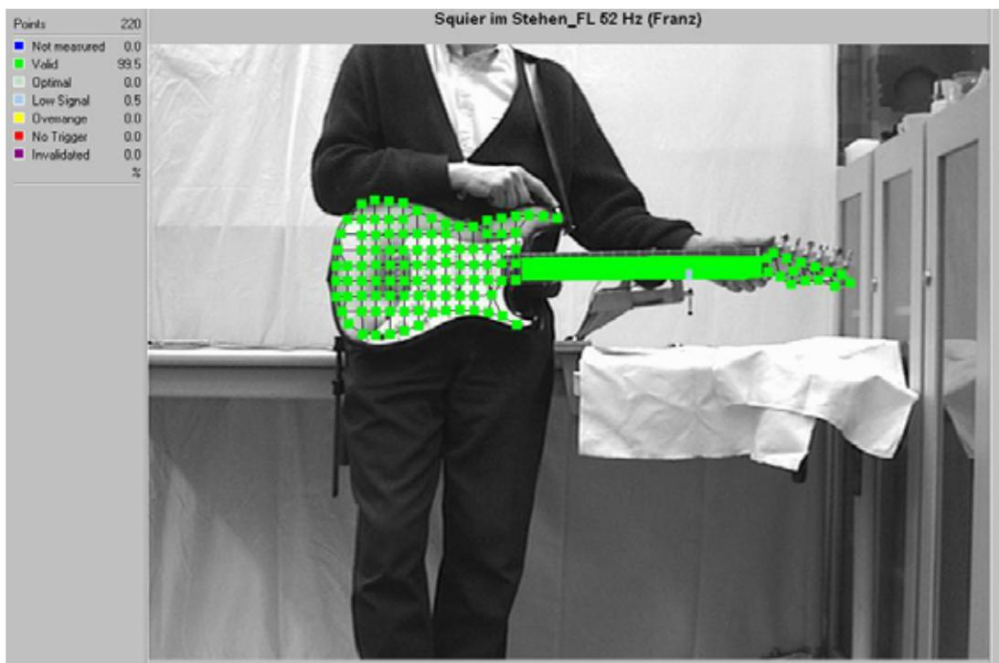
Abb. 59. Messgitter bei der Messung mit VP FL in stehender Spielhaltung; die Gitarre wird am Bund Nr. 7 angeregt.
