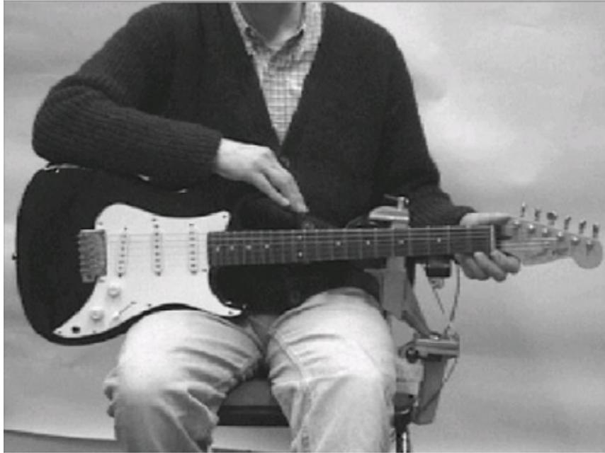
*Abb. 43. Gitarre auf dem Schoß der VP FL und am Bund Nr. 7 über einen Schwingerreger B&K 4810 angeregt.*
