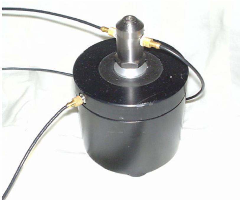
Abb. 7. Schwingerreger mit aufgesetztem Impedanz-Messkopf.
