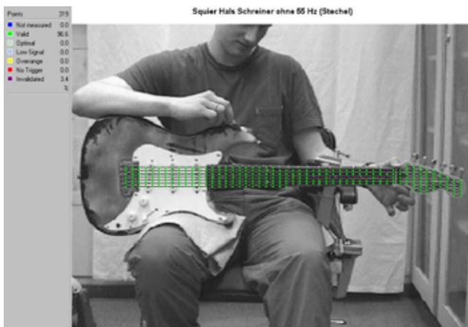
*Abb. 67a. Messgitter bei der Messung der Hals-Kopf-Schwingung mit VP SC in sitzender Spielhaltung; ohne Mittelung.*
