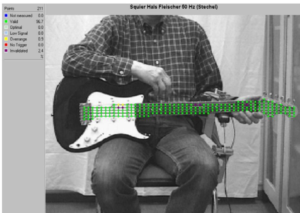
Abb. 62. Messgitter bei der Messung der Hals-Kopf-Schwingung mit VP FL in sitzender Spielhaltung; die Gitarre wird am Bund Nr. 7 angeregt.
