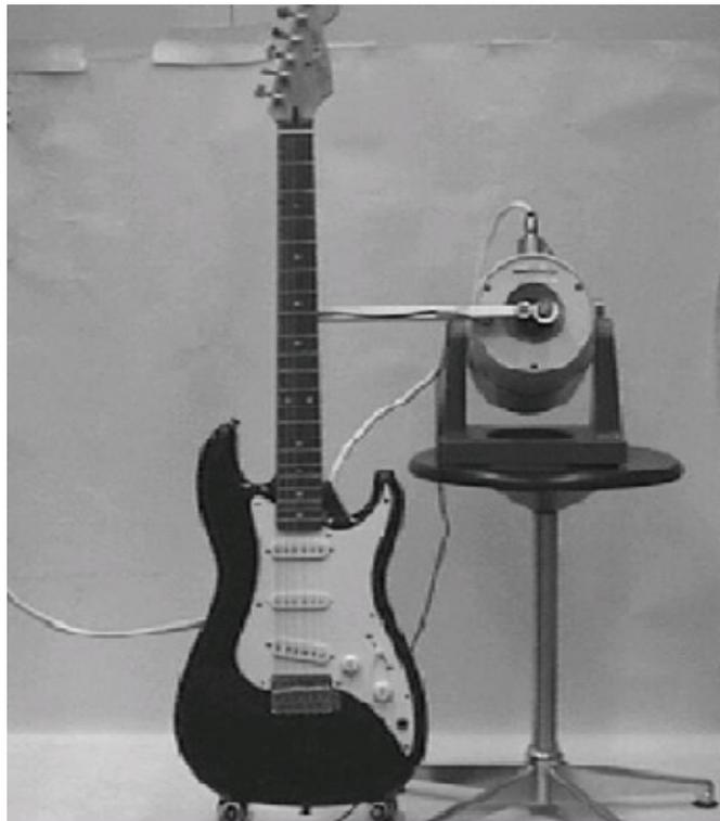
*Abb. 38. Gitarre im Gitarrenständer und am Bund Nr. 7 über einen Schwingerreger LDS V 406 angeregt.*
