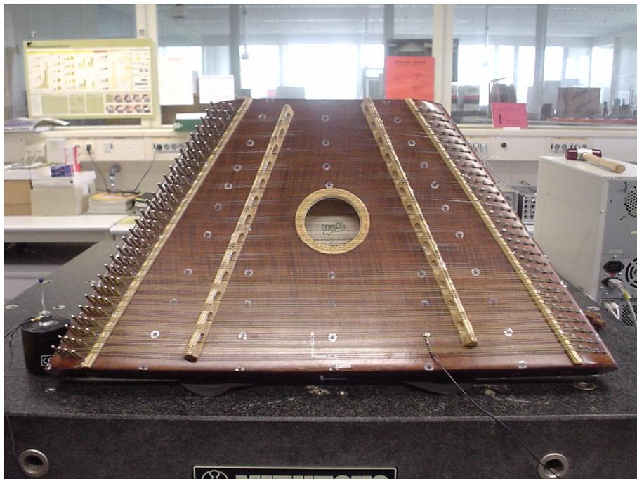
Abb. 8: Messsituation bei der Modalanalyse des Hackbretts. Links unten erkennt man den Schwingerreger mit Kraftaufnehmer, Verlängerung und Kunststoffspitze, rechts vorne den aufgeklebten Beschleunigungsaufnehmer.
