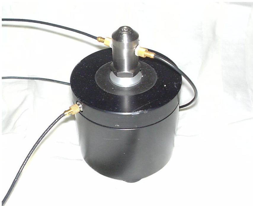
Abb. 40: Schwingerreger mit aufgesetztem Impedanz-Messkopf.
