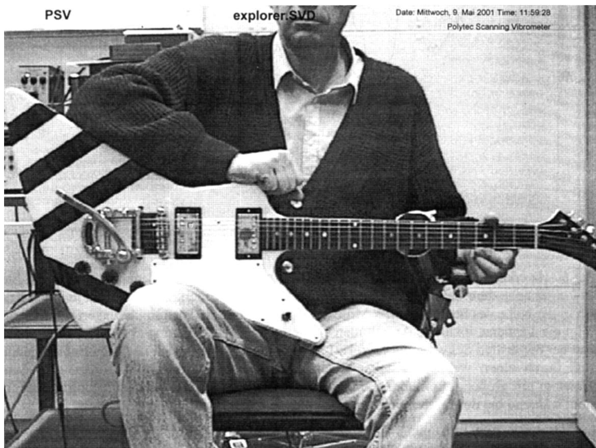
*Fig. 23. Instrument Nr. 2 (Gibson Explorer) während der Schwingungsmessung.*
