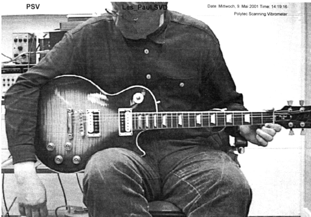
*Fig. 20. Instrument Nr. 1 (Gibson Les Paul) während der Schwingungsmessung.*
