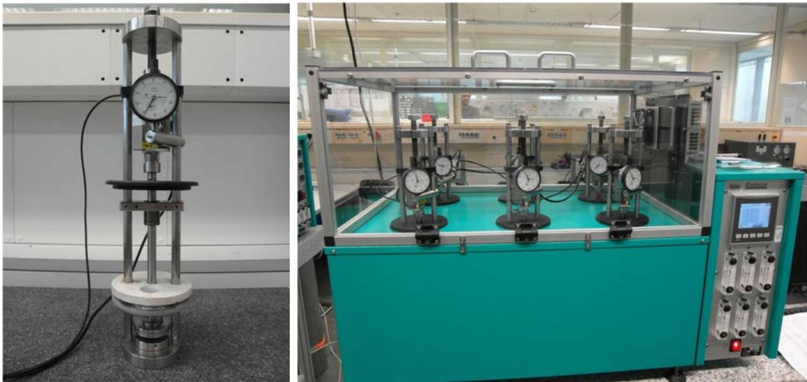
Abbildung 4.7: Chemische Spannungsrelaxation unter Druck.
