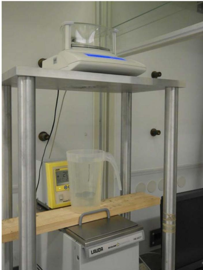
Abbildung 4.20: Aufbau des Volumendilatometers
