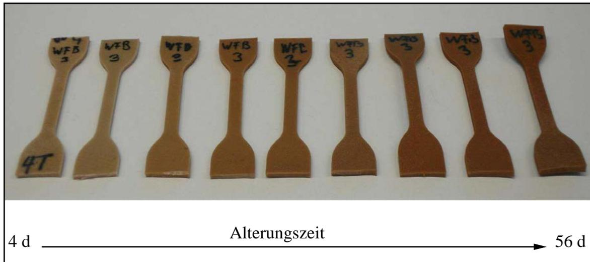
Abbildung 4.9: Lastfreie Alterung in Seewasser unter isothermen Bedingungen: Veränderung der Proben.
