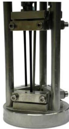
Abbildung 5.5: Versuchsaufbau zum gleichzeitigen Testen von drei Proben
