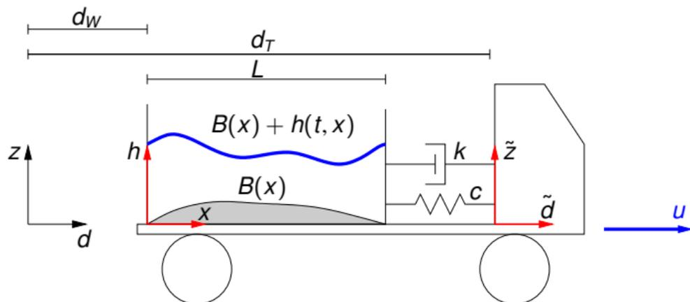
$m_T$ : Masse LKW,  $m_W$ : Masse Flüssigkeitscontainer,  $d_T$ : Wegstrecke LKW,  $d_W$ : Wegstrecke Container,
