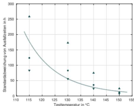
**Abbildung:** Ausgleichsrechnung über verschiedene Temperaturen  $T$  im Vergleich mit Messpunkten (Quadrate) samt Konfidenzintervallgrenzen zu  $q = 90\%$  (Dreiecke). Links für  $\mu_{krit}(T) \pm \sigma_{krit}(T)$ , in Rot eine Referenzkurve. Rechts  $\sigma_{krit}(T)$ . [K., Dvorsky, Ließ 2018]
