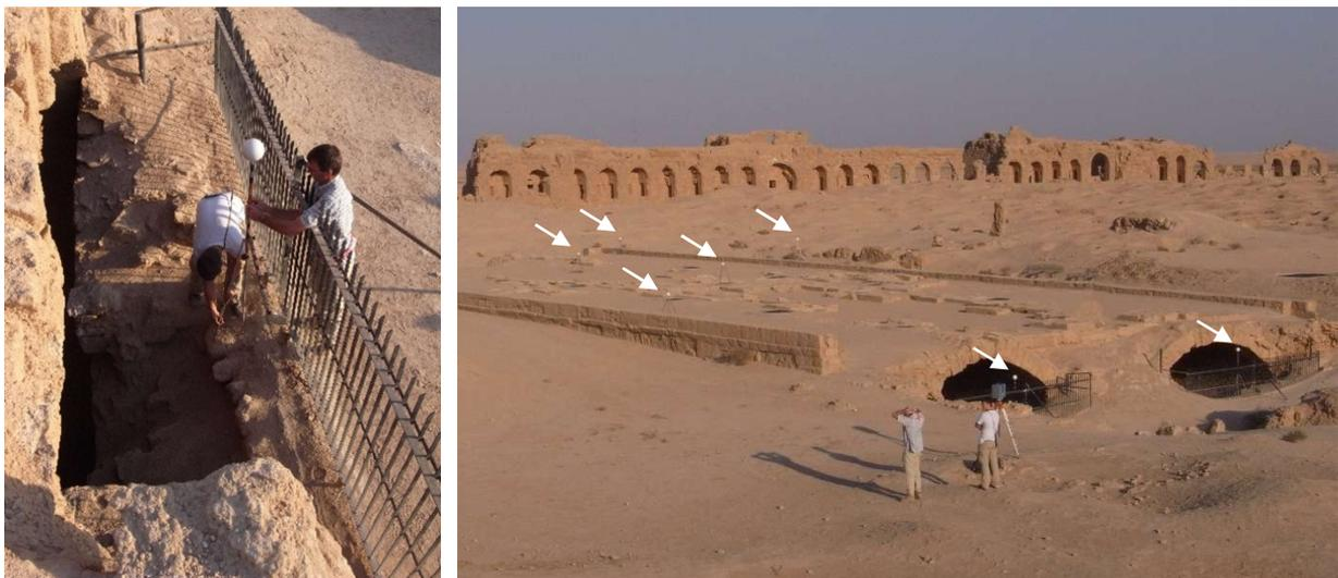
**Abb. 4.32** Verknüpfungspunkte für das TLS vom Außen- zum Innenbereich der großen Zisterne (2010)
