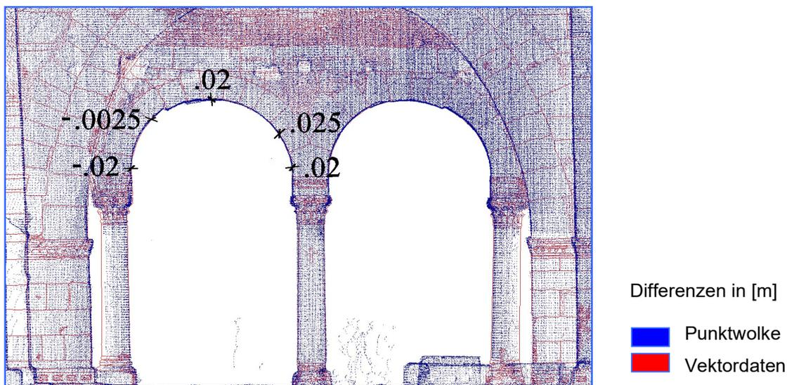
**Abb. 3.31** Differenzen an der westlichen Doppelarkade der nördlichen Mittelschiffswand. Überlagerung TLS-Punktwolke 2006 und vektorisierte Umzeichnung der Photo-grammetrie 1976/ 1977 (Grundlage ULBERT 1986, Beilage 9)
