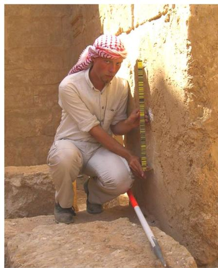
**Abb. 3.21** Einsatz der Invar-Kurzlatte (60 cm lang) (2006)
