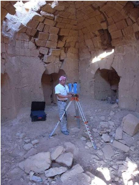
**Abb.4.30** TLS zu 3D-Aufnahme des Gewölbes im Turm T29 (2010)
