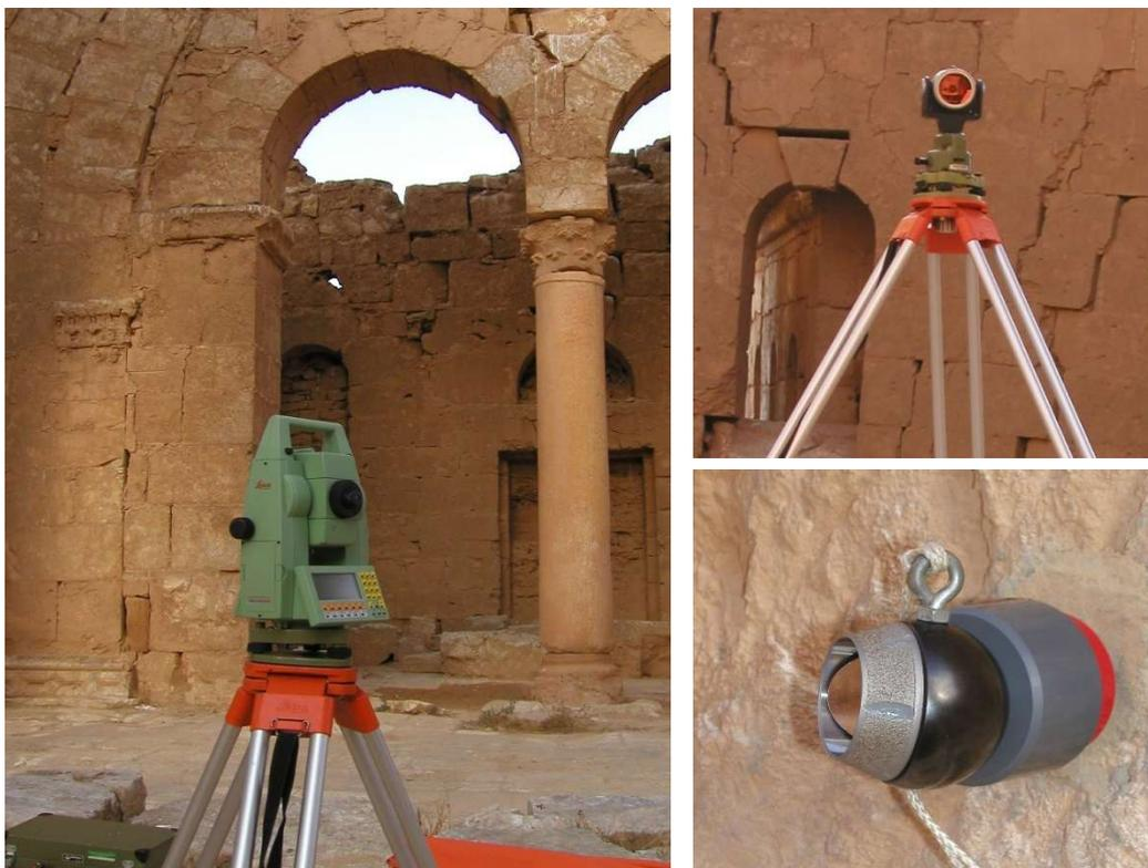
**Abb. 3.9** Tachymeter Leica TCRA 1101 plus, Präzisionsprisma Leica GPH1P (oben) und 1,5'' Corner Cube mit Magnetadapter (unten)
