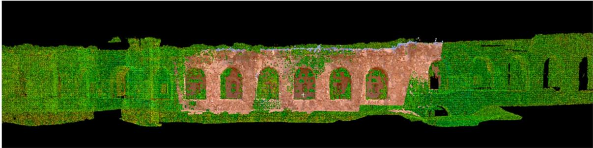
**Abb. 5.18** Zusammenführung von photogrammetrischer (braun) und gescannter Punktwolke (grün)
