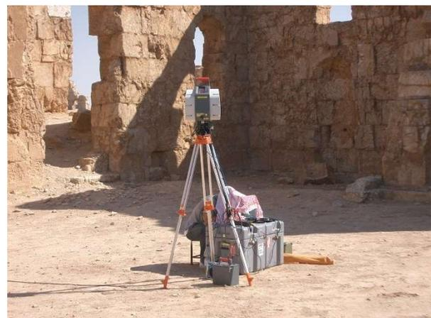
Abb. 32: Laserscanning im Außenraum der Basilika A
