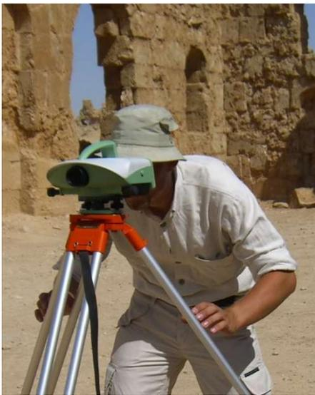
**Abb. 3.20** Messungen mit dem Digitalnivellier Leica DNA 03 (2006)
