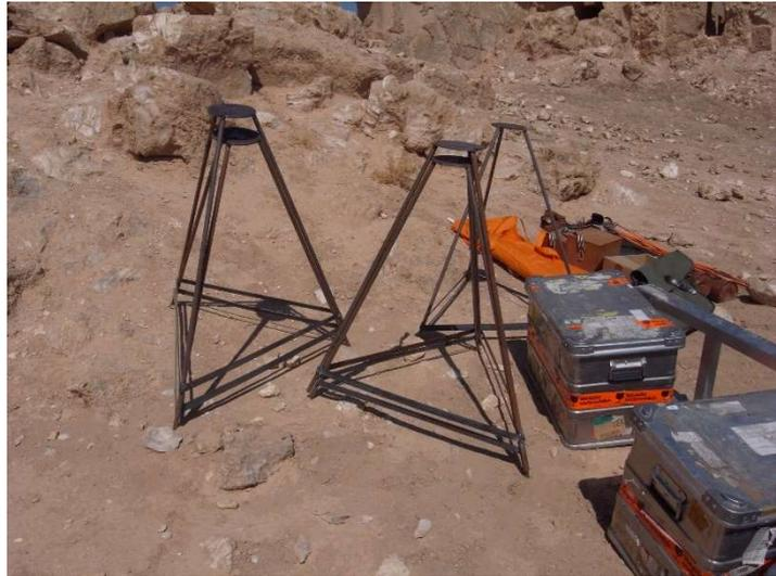
**Abb. 4.21** Kugelzielzeichen (Sphären) auf Stativ (links) und selbst gefertigte Eisenstative (Pyramiden) (rechts) (2010)
