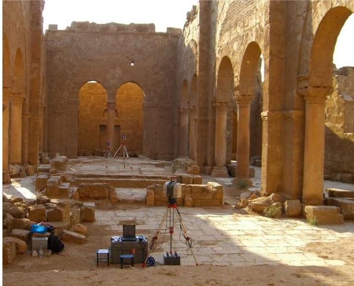
**Abb. 3.23** Einsatz des terrestrischen Laserscanners Leica HDS 3000 im Hauptschiff der Basilika A (2006)
