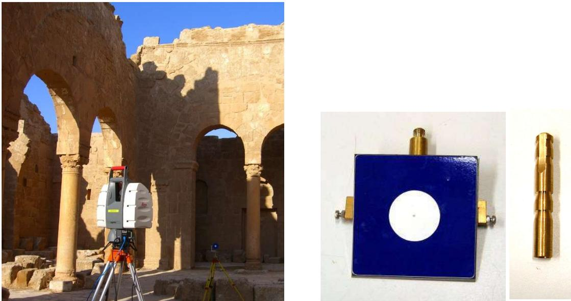
**Abb. 4.1** Terrestrischer Laserscanner Leica HDS 300 mit spezieller Zielmarke und Wandadapter (2006)
