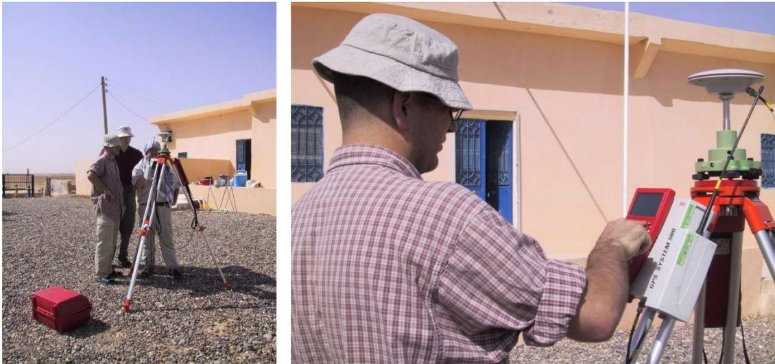
Foto 27: Funktionsprüfung der GPS - Receiver
