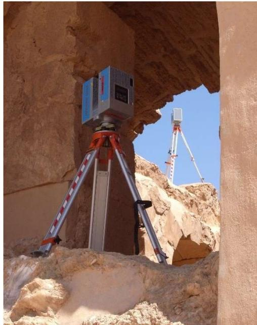
**Abb. 4. 20** Paralleler Einsatz der zwei Laserscanner IMAGER 5006 von Z+F (2010)
