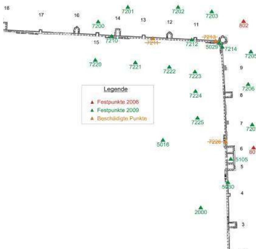
**Abb. 4.19** Übersicht der Referenzpunkte zur Aufnahme der Stadtmauer und des Osttores durch TLS (Messkampagne 2010)
