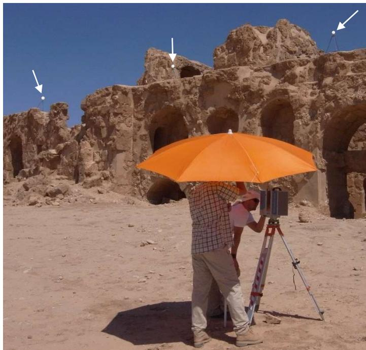
**Abb. 4.22** Positionierung der Eisenstative (Pyramiden) mit Kugelzielzeichen (Sphären) auf der Stadtmauer (2010)
