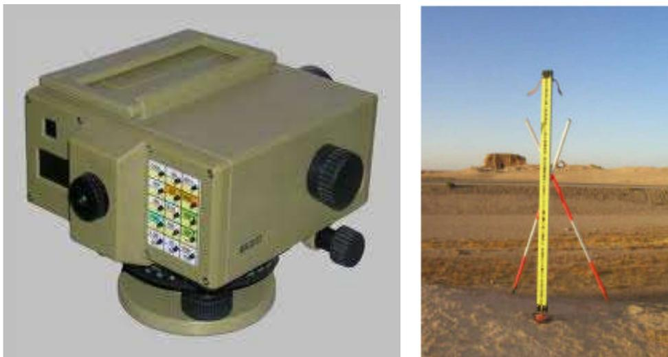
**Abb. 3.7** Präzisions-Nivellement mit Leica NA 3003 mit 2m Code Invar-Latte
