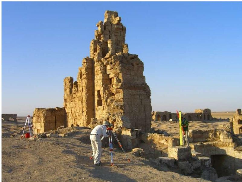
Abb. 35: Nivellement im Außenraum
