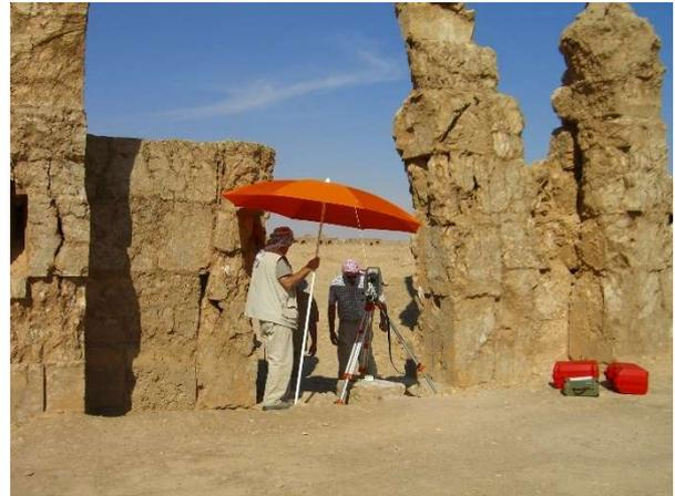
Abb. 29: Einmessung der neu vermarkten Punkte
