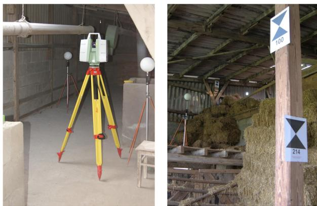
*Links:* Der terrestrische Laserscanner Leica ScanStation C10 bei einer Aufstellung im Innenbereich. Von 30 Standpunkten aus wurden Rundum-Scans in mittlerer Auflösung gemessen. Gesamte Arbeitszeit vor Ort: rund neun Stunden.
