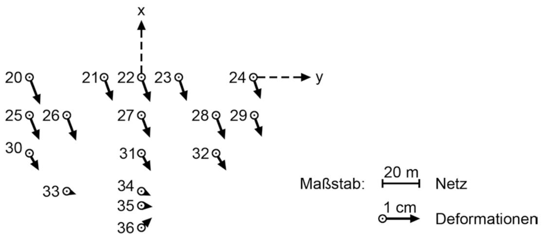
Abbildung 12 Aus der Trendfunktion resultierende Verschiebungen der Objektpunkte in der xy-Ebene
